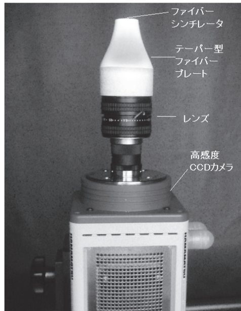
図1 開発した超高分解能リアルタイム放射線イメージング装置の写真
