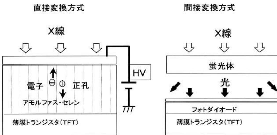
図3. フラットパネルディテクタの構造
