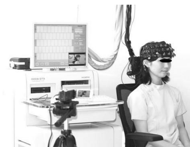
図2 多チャンネル fNIRS 脳機能計測システム
