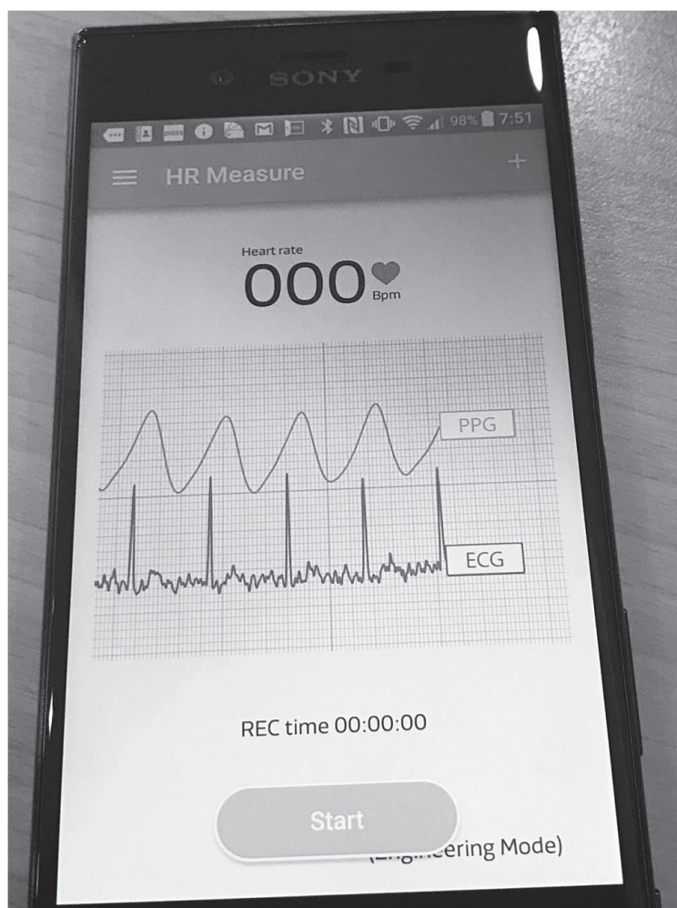
図2 ウェアラブルデバイスからスマートフォンに無線（BlueTooth）経由で送信された心電図と脈波のデータを示す。高品質の心電図が測定できていることがわかる。
