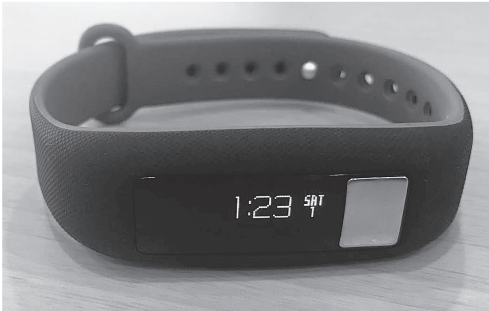
図1 Simplex Quantum 社が開発した、心電図と血圧が同時計測できる時計型のウェアラブルデバイスの外観。表示画面の裏側に緑色の LED を搭載、表示画面横のセンサー部分に反対の指を押し当てて30秒間脈波と心電図を同時計測することが可能で、この二種のデータから Moens-Korteweg 式により伝播時間を算出し、最高血圧・最低血圧の計算値を示すものである。
